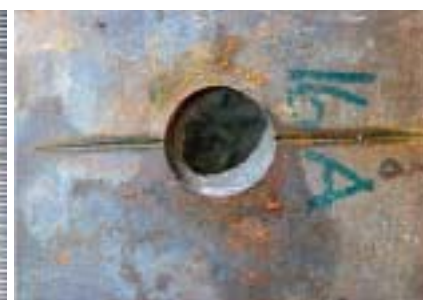
FIGURA 10 - FORO DA 25 MM, INTASATO CON STRATO DI MALTA CONFINATA RISPETTIVAMENTE: AL MOMENTO DELLA FILTRAZIONE, DELLO SCOPPIO ED AL TERMINE DELLA PROVA
