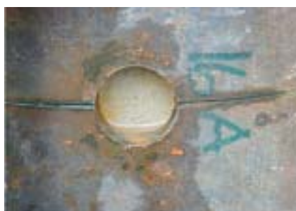
FIGURA 10 - FORO DA 25 MM, INTASATO CON STRATO DI MALTA CONFINATA RISPETTIVAMENTE: AL MOMENTO DELLA FILTRAZIONE, DELLO SCOPPIO ED AL TERMINE DELLA PROVA
